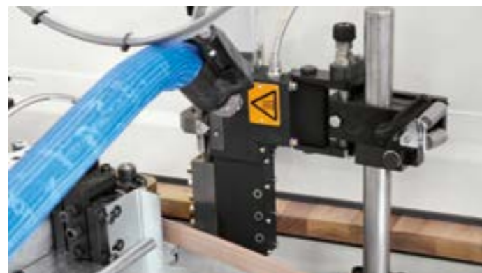
Щелевой агрегат для нанесения клея на торец панели.
